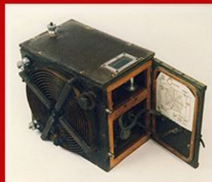
WWI Sterling set, Un émetteur à étincelles désigné aussi comme émetteur à ondes amorties utilisé dans les avions, principalement pour le repérage d'artillerie
